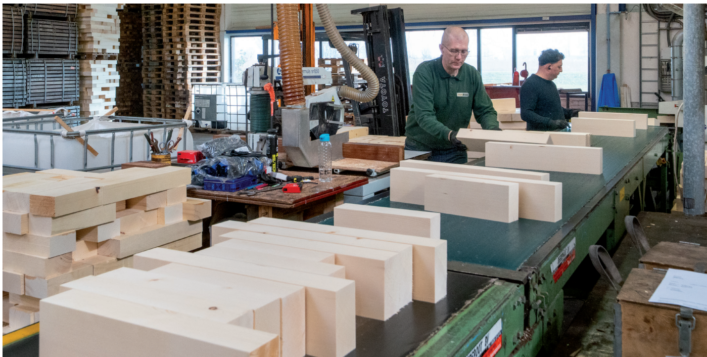
Het goede hout wordt naar de vingerlasstraat geleid.
