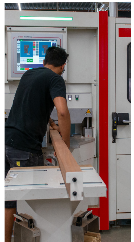
Lijmen. Vroeger met de hand, nu met de robot.
