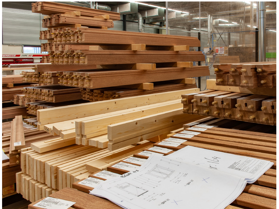
De geprofileerde delen worden tot kozijnen verlijmd.
