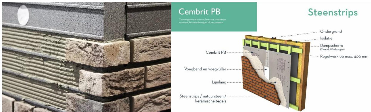
Figuur 13 links: voorbeeld gevel van keramische steenstrips, rechts een opbouw in de gevel. bron: (BMN, 2020)
