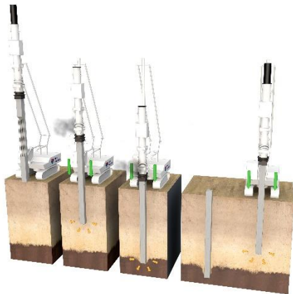
Figuur 3 proces inbrengen prefab heipalen bron: (Franki foundations, 2020)
